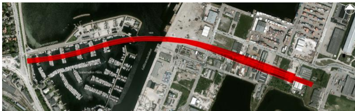
Figur 1-3 – Linjeføring for vej-tunnelforslag A og B.
