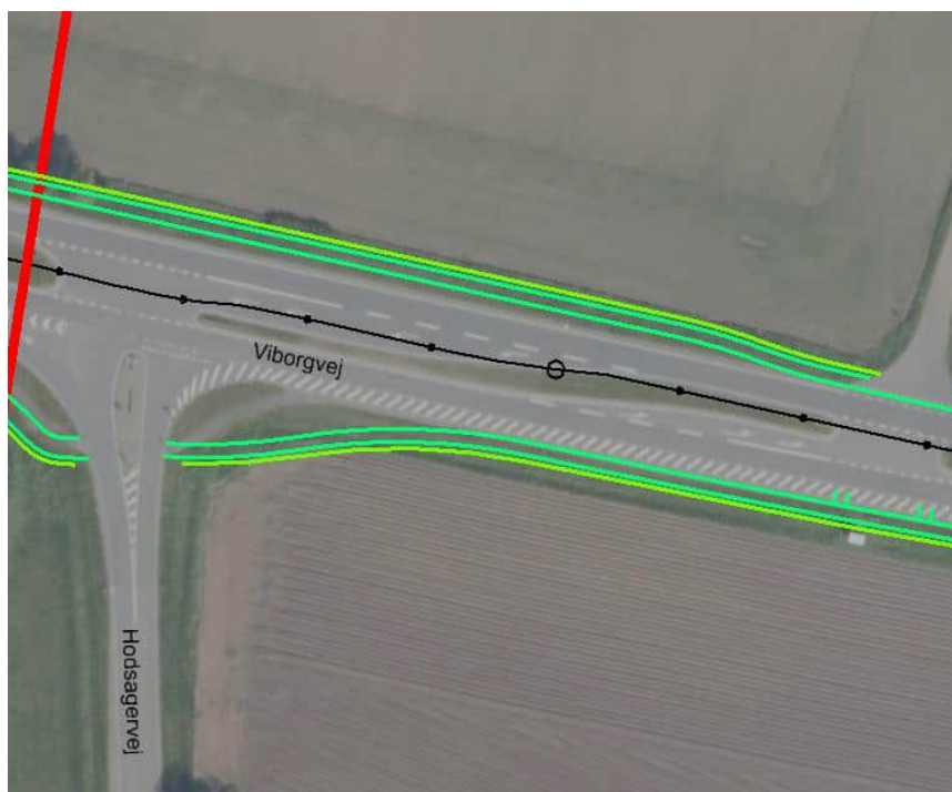
Figur 5: Eksempel på krydsende højspændingsledning over Viborgvej.
