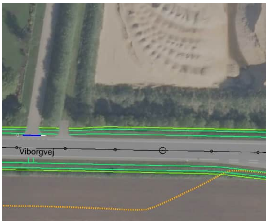
Figur 4: Eksempel på langsgående gasledning på den sydlige side af Viborgvej.
