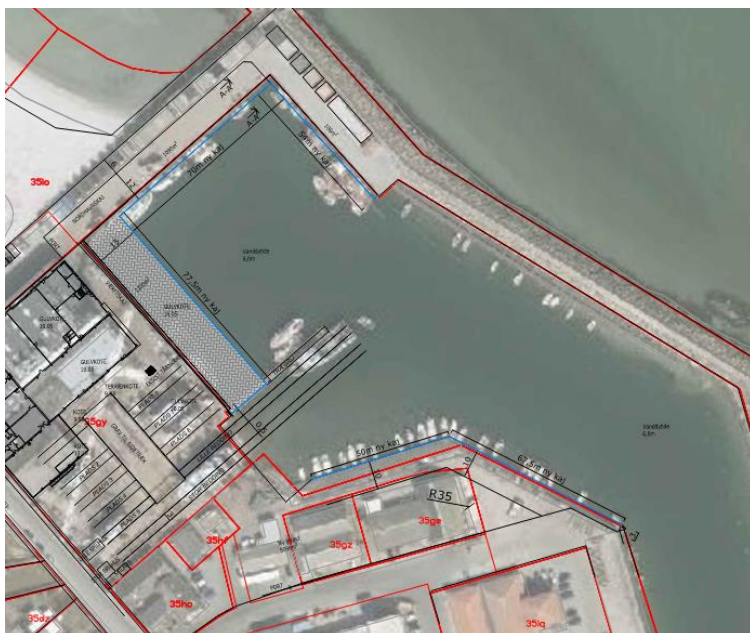
Figur 1 - Illustration af eksist. og fremtidige forhold. De blå optegnede linjer viser fremtidige forhold, hvor luftfotoet viser eksist. forhold, se også vedlagte tegning 110.
